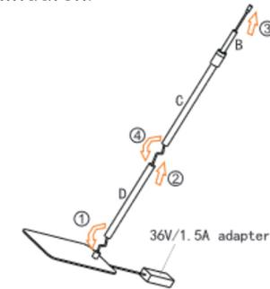
1. Verbinden Sie beide Teile des Netzkabels.
